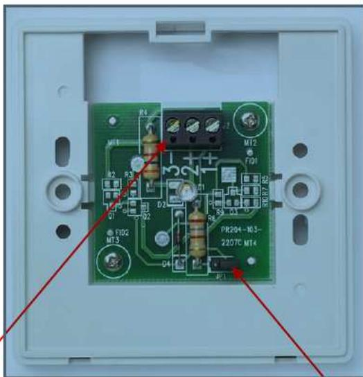
Входы разъема **J2** имеют разную полярность: 1 (+), 2(+) и 3(-). Соединение **JP1**
