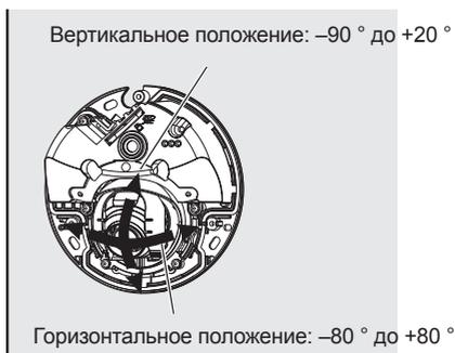
Горизонтальное положение:  $-80^{\circ}$  до  $+80^{\circ}$
